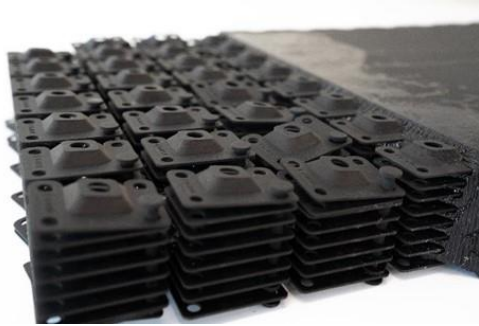
Bauteile sind von einer Supportstruktur umhüllt
