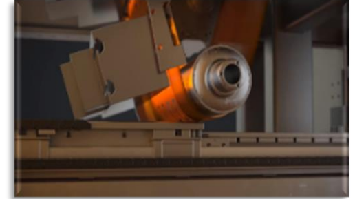
Das Band überträgt die Schicht mit Hitze und Druck auf eine Schiebebühne
